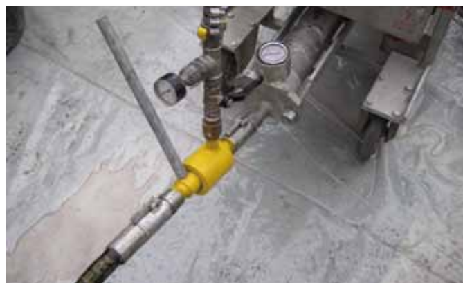
Iniettore per aria, l'adduzione d'aria compressa mantiene una portata costante del materiale filtrante nello stesso getto d'aria.
