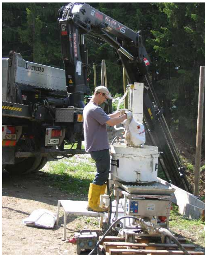
DRILL DRAIN® - Pompa a vite globoidale con miscelazione forzata, necessario attacco corrente da 380 V, attacco acqua per tubo flessibile da 1/2", peso ca. 420 kg, dispositivo per il dosaggio dell'acqua.
